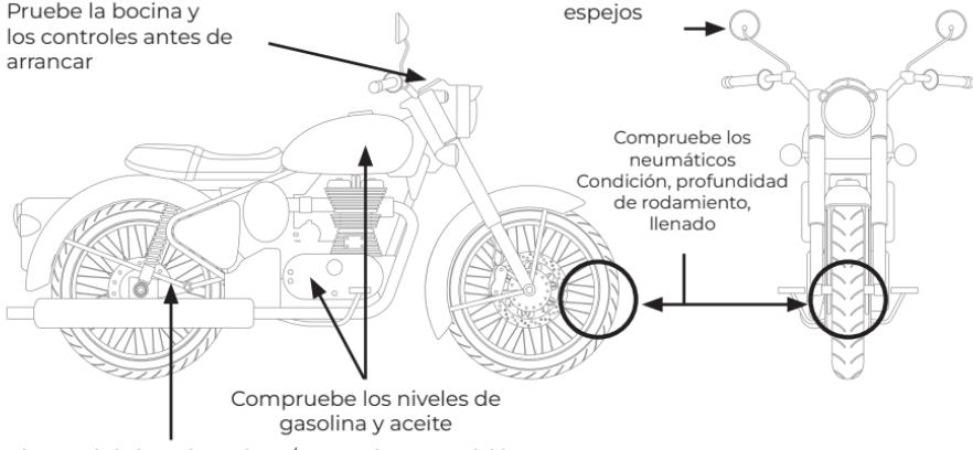
Ajuste y lubrique la cadena/correa de transmisión
